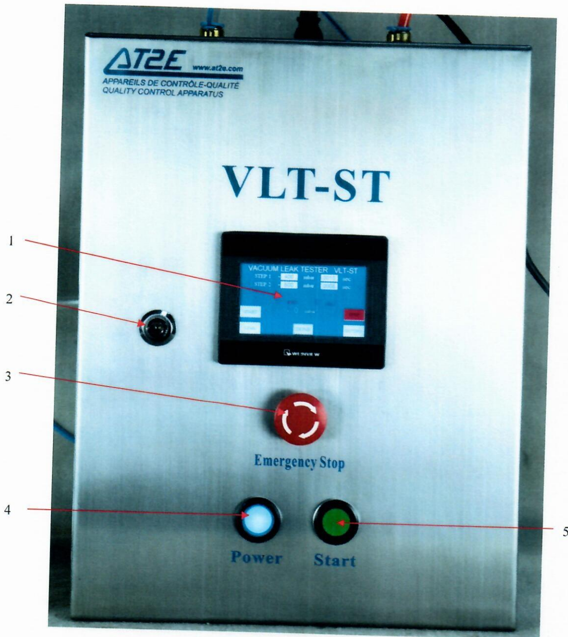
1). Touching screen 2). Door lock 3). Emergency stop button 4). Power switch 5). Start switch
